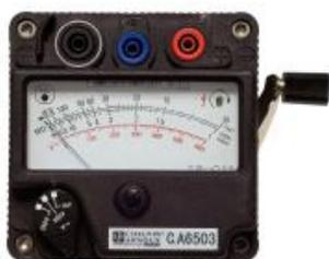
**Измеритель сопротивления изоляции С.А
