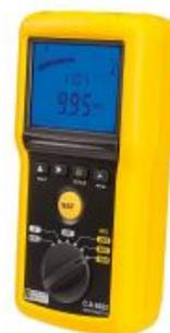
**Измеритель сопротивления изоляции С.А
