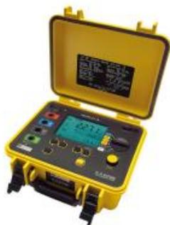
**Измеритель сопротивления заземления**
