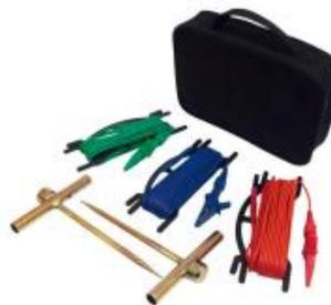
**Дополнительный комплект для измерения сопротивления заземления P01102021**
