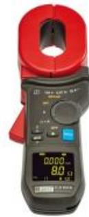
**Измеритель сопротивления заземления
