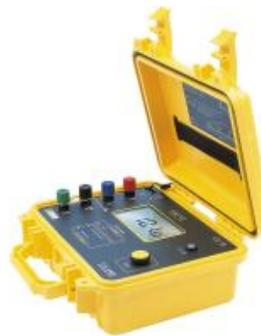
**Измеритель сопротивления заземления
